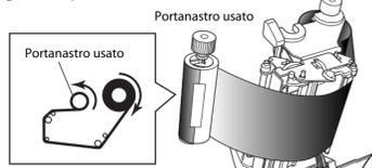
f. Introdurre il portanastro su cui è stato installato il tubo di carta nell'unità nastro, quindi farlo ruotare nella direzione indicata dalla freccia in modo da tendere il nastro ed eliminare eventuali pieghe e increspature.
