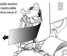
e. Usando la parte superiore adesiva del nastro o del nastro adesivo, fissate il nastro estratto sul portanastro, su cui è stato installato il tubo, e avvolgetelo sul portanastro.
